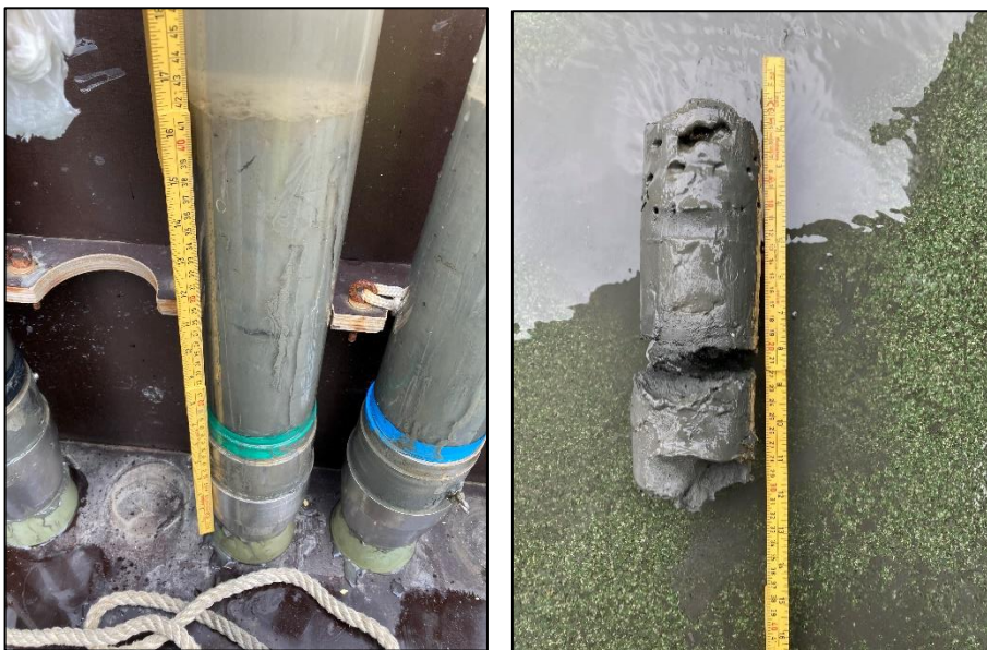
Figur 16. Prøvetakning av sediment utenfor Fuglevik, stasjon 4, for analyse av metaller og organiske miljøgifter, samt TOC og kornfordeling.
